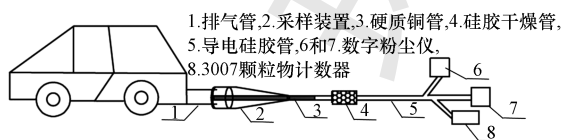
图 1 机动车尾气颗粒物测量实验装置
